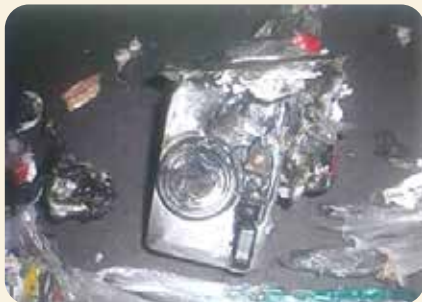
発火原因となったデジタルカメラ (リチウムイオン電池内蔵)
